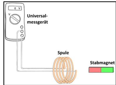
Nähert man den Stabmagneten an die Spule an, zeigt das Messgerät einen Wert von + 1,0 Volt an.
