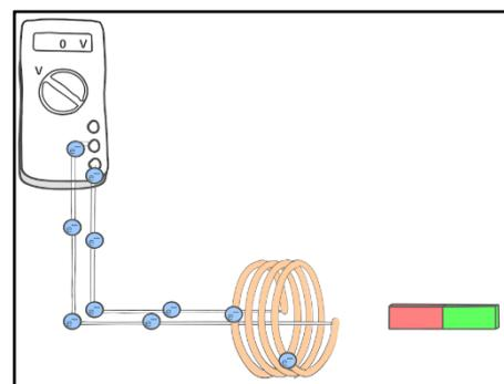
Nähert man nun den Stabmagnet an die Spule an, so fließen die Elektronen in der Spule in eine bestimmte Richtung. Dadurch befinden sich am Ende des rechten Stromkabels, das mit dem Spannungsmessgerät verbunden ist, mehr freie Elektronen als am Ende des linken Stromkabels. In diesem Fall zeigt das Messgerät einen Wert von plus 1,0 Volt an.
