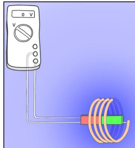
Erst wenn sich die Stärke des Magnetfelds, das die Spule durchzieht, ändert, wird wieder eine Spannung induziert.
