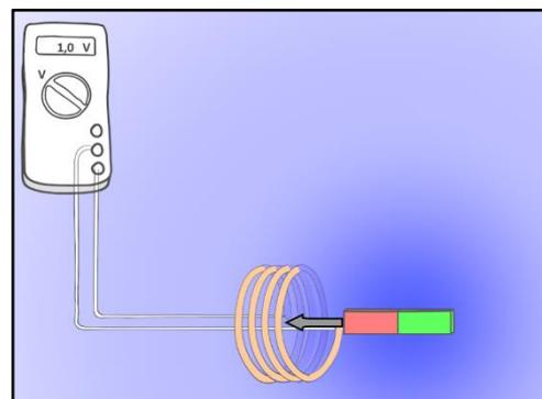
Erst wenn man den Stabmagneten nicht mehr bewegt, bleibt die Magnetfeldstärke, die die Spule durchzieht, konstant. Das hat zur Folge, dass keine Spannung mehr in der Spule induziert wird.
