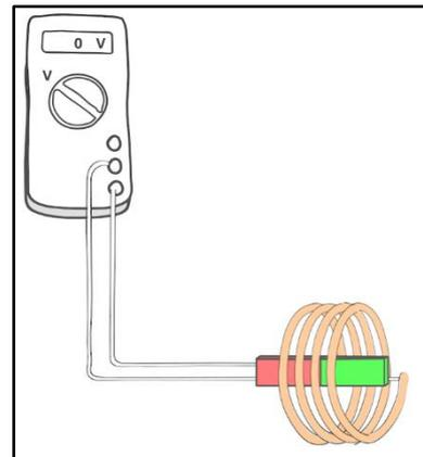
Entfernt man den Stabmagneten von der Spule, zeigt das Messgerät einen Wert von - 1,0 Volt an.
