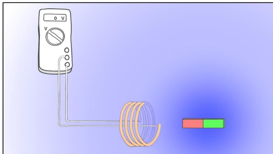
Bewegt man den Magneten in Richtung der Spule, verändert sich die Stärke des Magnetfelds, das die Spule durchzieht. Bei dieser Veränderung der Magnetfeldstärke, wird eine Spannung in der Spule induziert.
