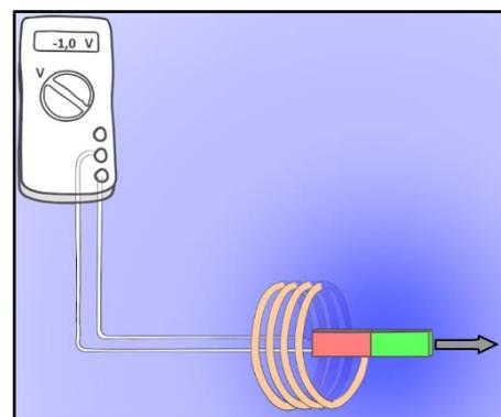
Aber wieso zeigt das Messgerät einmal einen Wert von plus 1,0 Volt und einem einen Wert von minus 1,0 Volt an? Um dieses anschaulich zu erklären, schauen wir uns die Bewegung einiger freier Elektronen in der Spule und in den Stromkabeln an.
