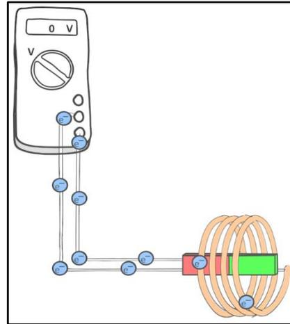
Entfernt man den Stabmagneten von der Spule, fließen die freien Elektronen in der Spule in die entgegengesetzte Richtung. Nun befinden sich mehr freie Elektronen am Ende des linken Stromkabels. In diesem Fall zeigt das Messgerät einen Wert von minus 1,0 Volt an.
